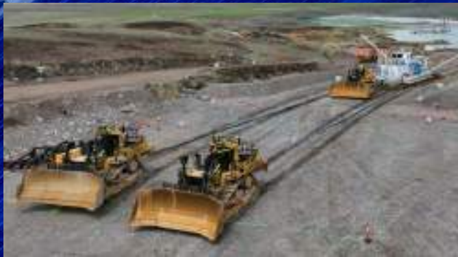
スマートブルドーザー プライベート5Gで鉱山の危険な場所での作業を無人化(オーストラリア)
